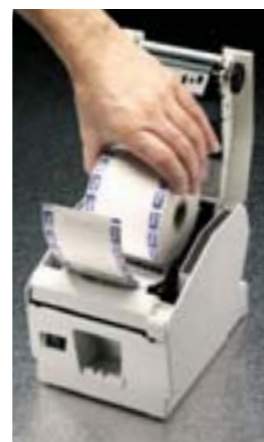
« Insertion et impression », chargement papier simplifié
